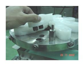
6) Установите акриловую крышку на фиксирующие болты. Затяните фиксирующие болты акриловой крышки. Нанесите специальную пищевую смазку подходящую для фторопластовых поверхностей, либо животный жир на ножи (не используйте растительное масло в качестве смазки для ножей).
